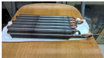
鰭管型脈衝式熱管熱交換器 1. 緊湊排列→體積小 2. 一次充填→成本低 3. 熱傳面積多→熱傳量高
